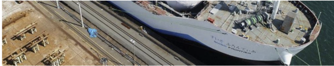
液化水素タンクを搭載する川崎重工の運搬船「すいそふうんていあ」= 3月、兵庫県播磨町（同社提供）
