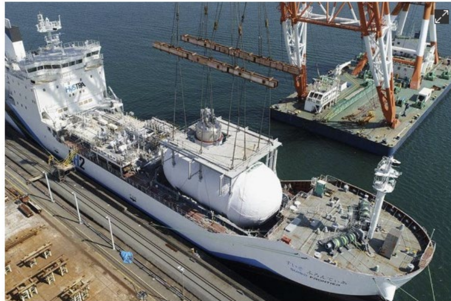
液化水素タンクを搭載する川崎重工業の運搬船「すいそふろんていあ」＝3月、兵庫県播磨町（同社提供）
